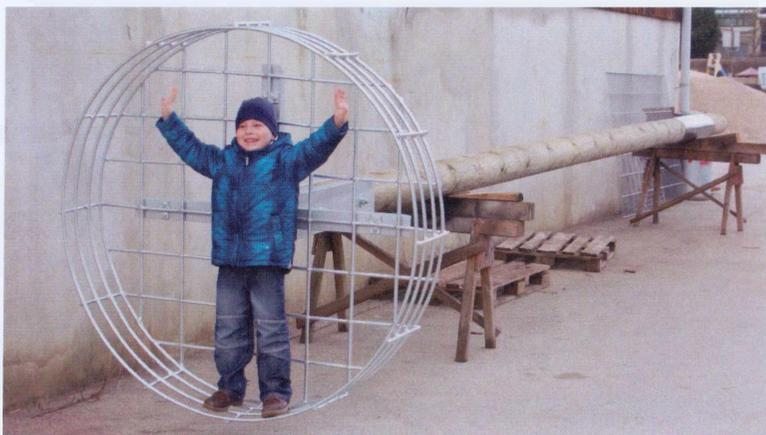
Storchennest mit „Nachwuchs“: Fertig verschweißt, verschraubt und feuerverzinkt zeigt sich die Nisthilfe mit einem großzügigen Durchmesser von 1,5 m. (Foto v. 1.4.2015)
